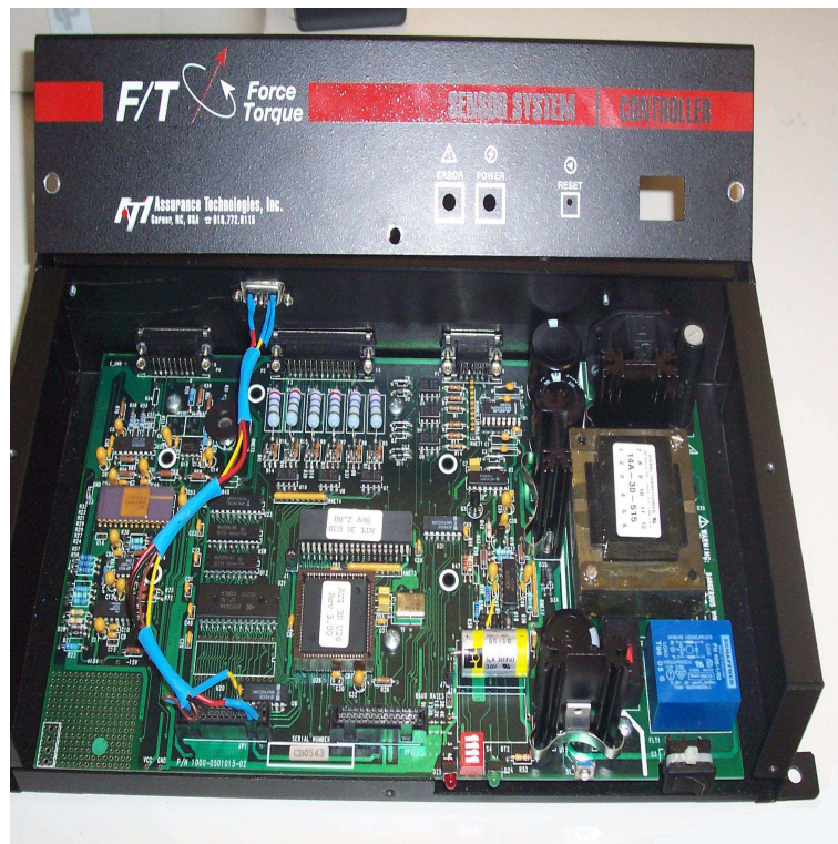
Figura 5.10: Cableado interno de las señales de alimentación del controlador
