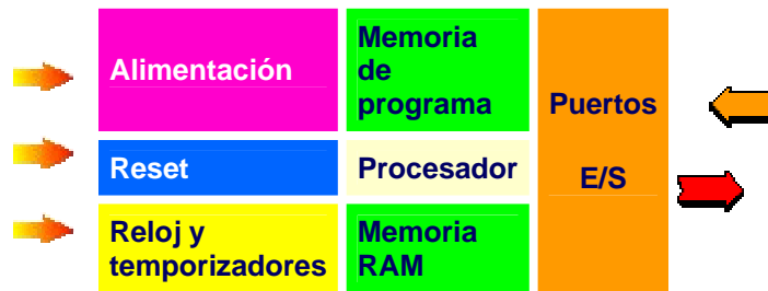
Figura 3.1 Representación esquemática de un microcontrolador
