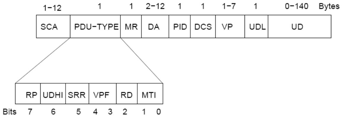
Figura 4.6 Estructura de la PDU SMS-SUBMIT
