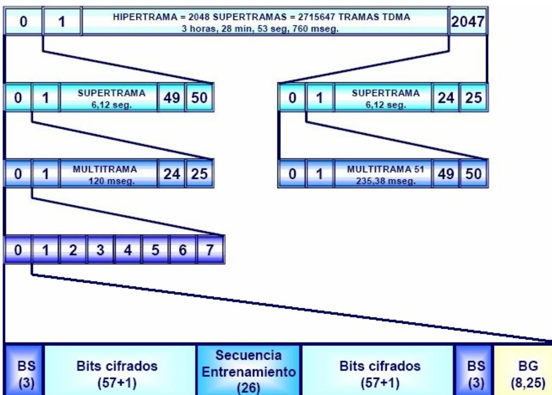
Figura 4.2 Diagrama de entramado GSM
