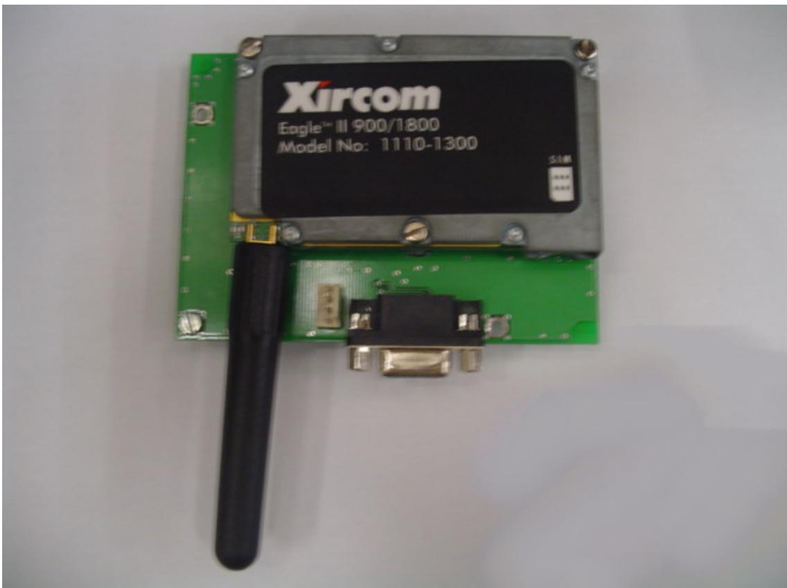
**Figura 4.9** *Módem GSM más placa adaptadora (anverso)*
