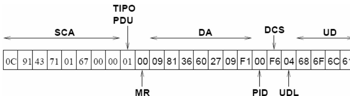
Figura 4.8 Ejemplo de PDU SMS
