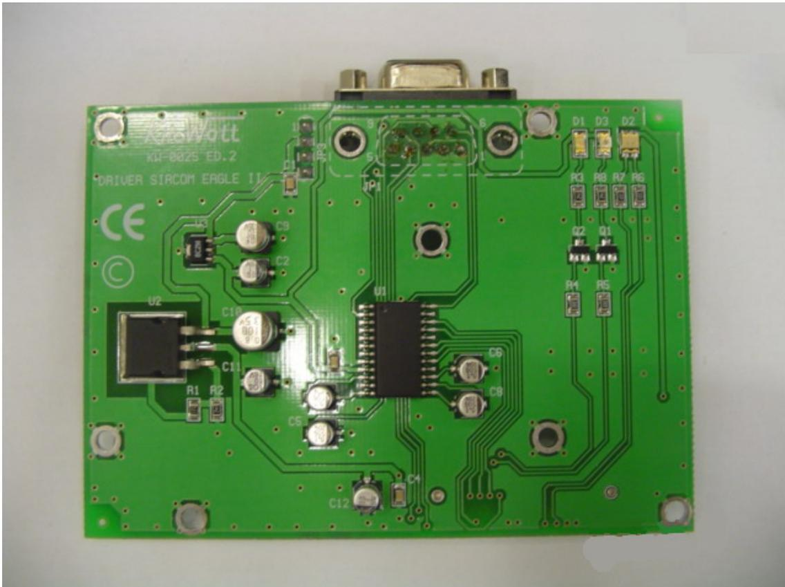
**Figura 4.10** *Módem GSM más placa adaptadora (reverso)*
