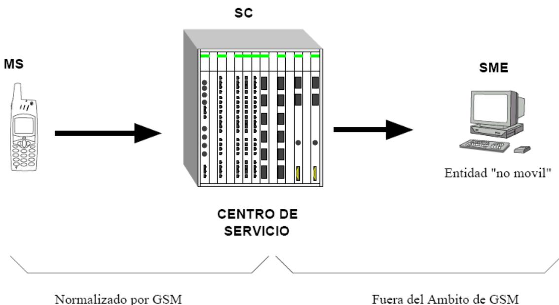
**Figura 4.3** Estructura del servicio SMS
