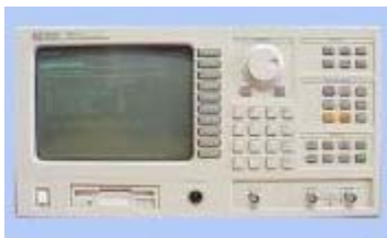
Figura 2.4 Analizador de Red
