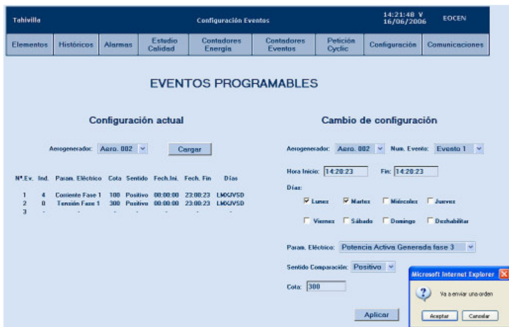
Imagen 40: Pantalla de configuración de eventos programables. Muestra el momento en que se pide la conformidad antes de enviar una configuración nueva con los parámetros elegidos
