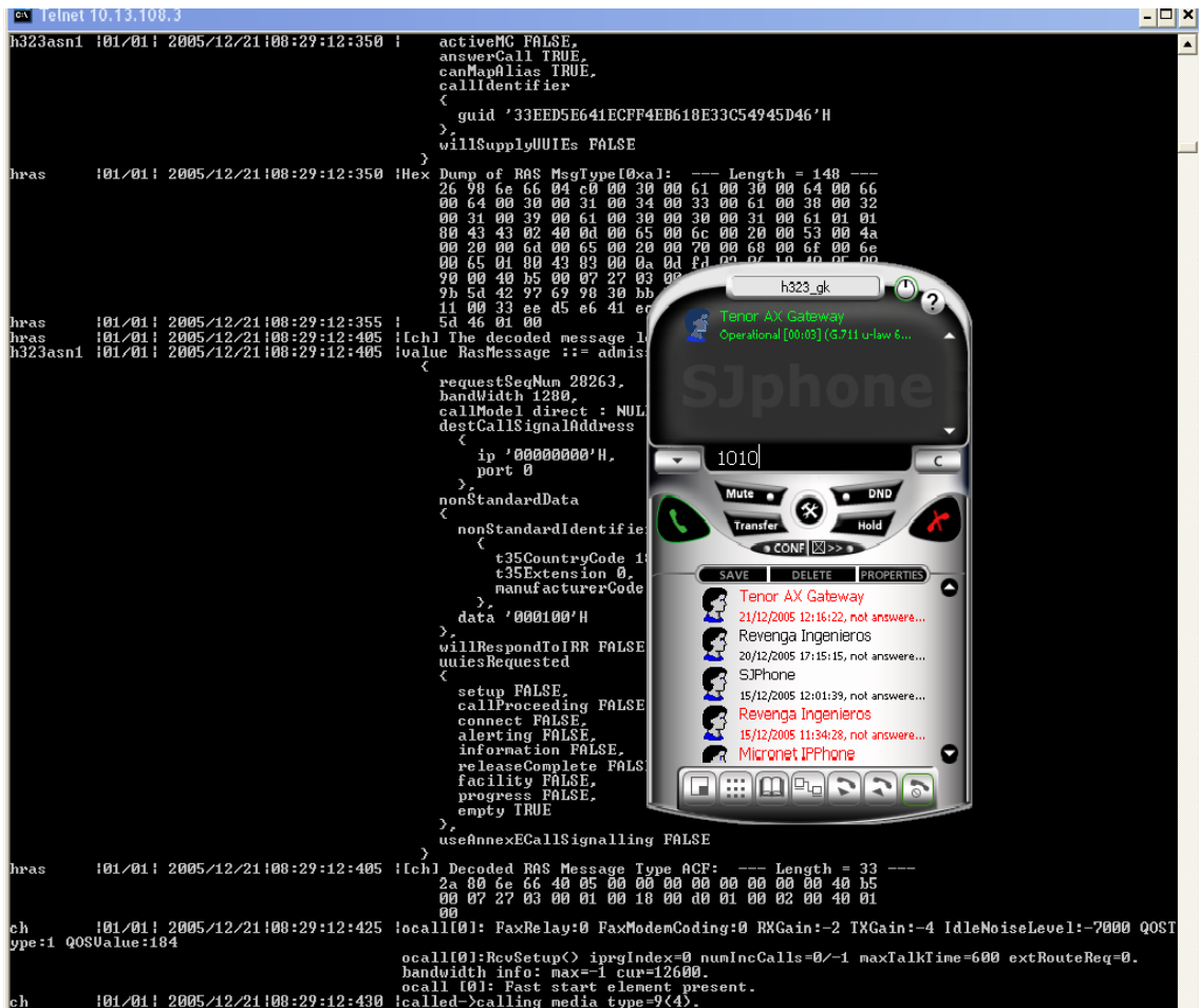
Figura 97: Muestra de los logs de los equipos Quintum Tenor mientras reciben una llamada, en este caso, del SJPhone.
