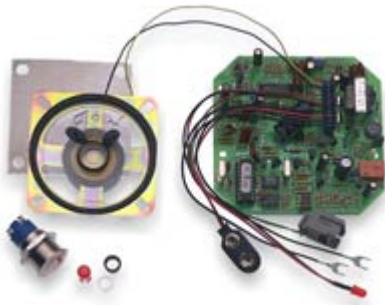
Figura 29: Interfono Viking 1600A sin carcasa.
