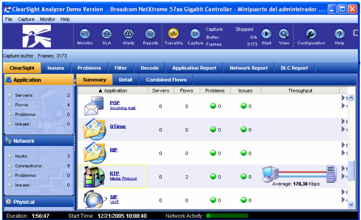
Figura A5: El Programa para auditorías de red ClearSight: pestaña Sumario, monitorización en tiempo real.
