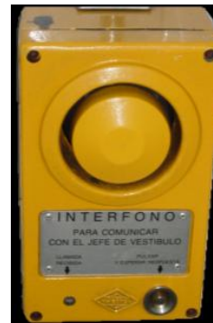
Figura 30: Interfono montado en carcasa.
