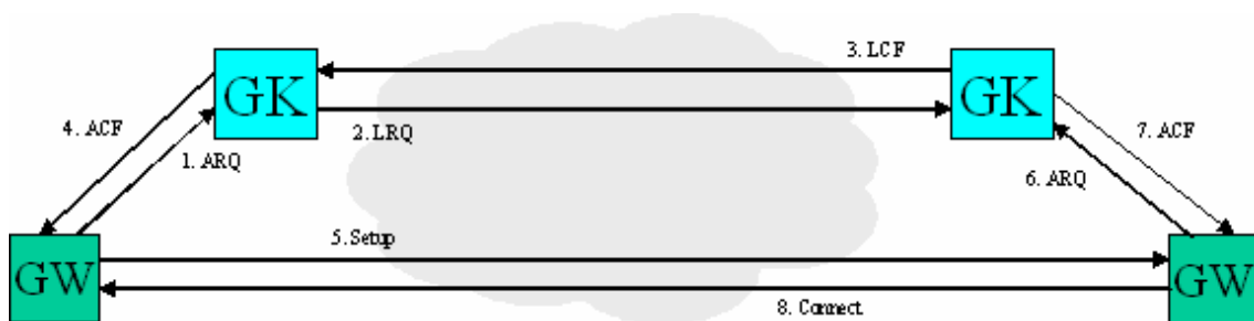
Figura 23: Diagrama de establecimiento de llamada RAS + H.225.0
