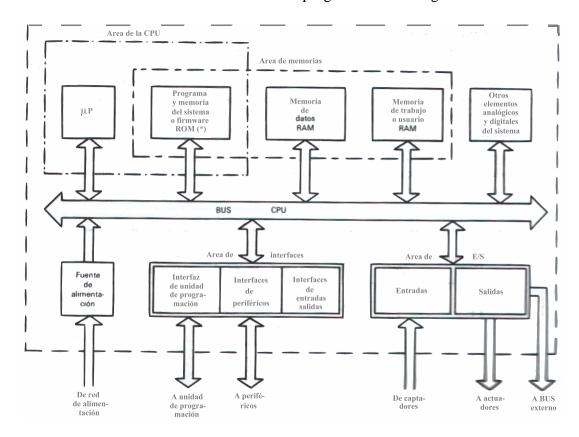
Figura 1.1. Estructura básica de un PLC
