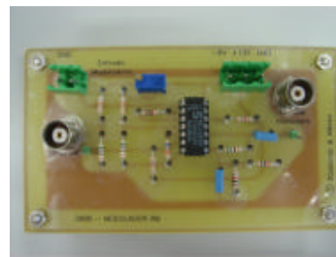
Ilustración 11: Modulador AM (versión anterior)
