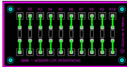
Ilustración 46: Esquemático P-CAD de Medidor LCR: Resistencias
