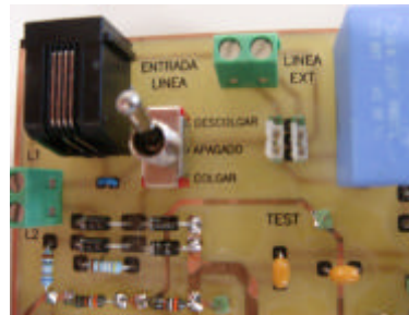
Ilustración 29: Detalle del conmutador de alimentación del Teléfono (versión nueva)
