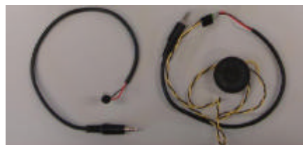
Ilustración 33: Micrófono y altavoz con conectores Jack (versión nueva)
