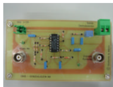
Ilustración 13: Demodulador AM (versión anterior)
