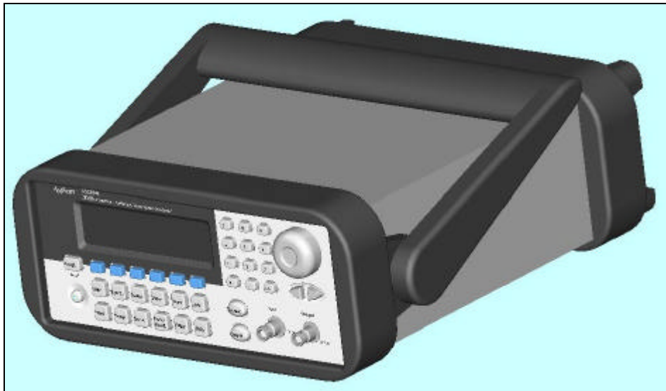
Ilustración 86: Equipo de instrumentación electrónica Agilent 33220A modelado en VRML y visualizado en un navegador web
