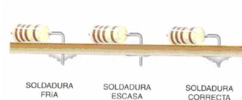
Además del tiempo de soldadura, mayor para terminales o zonas de cobre más grandes, es necesario aprender a dosificar la cantidad de estaño. Una soldadura con poco estaño puede ceder por efecto de vibraciones, mientras que utilizando demasiado se corre el riesgo de soldar varias "pistas" de cobre.
