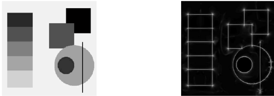
Ilustración 2.1 Izquierda: Imagen en escalas de grises con formas rectangulares y circulares. Derecha: PC de la imagen anterior.
