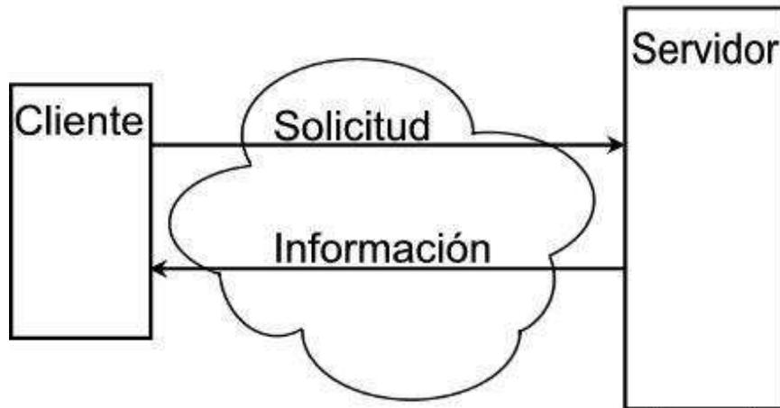
Figura 13. Esquema donde se muestra una comunicación cliente-servidor.
