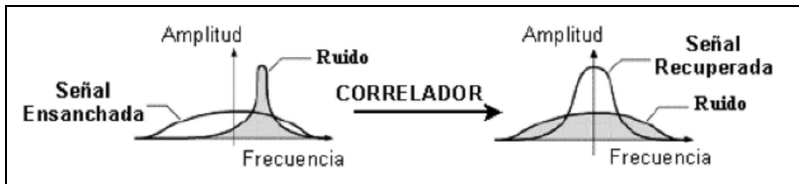
Ilustración 2-15: Efecto del ensanchado sobre el ruido.
