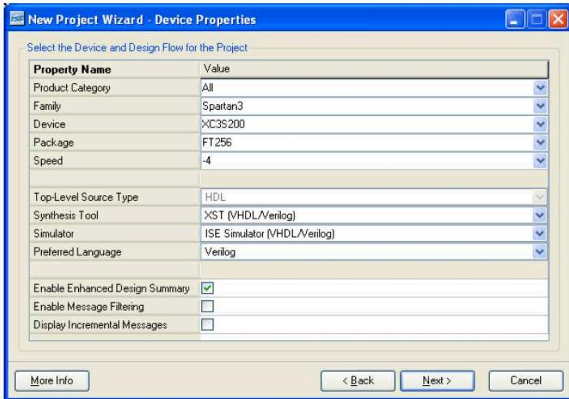
**Imagen 12.** Ventana de diálogo Device Properties en la creación de un proyecto.
