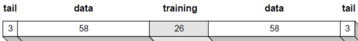
Figura 3.3 Ejemplo de trama GSM con inserción de secuencia de entrenamiento [10]
