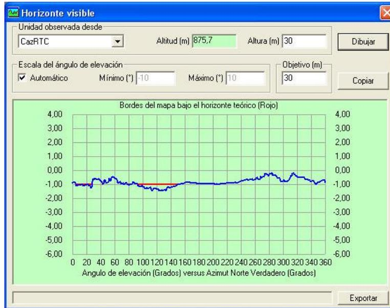
Figura 9.19 – Valores del ángulo de elevación de la antena situada en CazRTC correspondientes a los puntos de altura máxima visible
