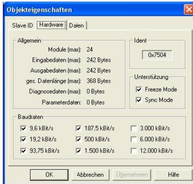
Fig 2.2: Configuración comunicación WinMod
