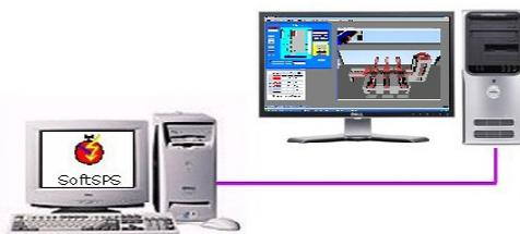
Para conectar un control externo para el modelo diseñado en WinMod, éste último debe configurarse en modo mono-esclavo. Por esta razón la herramienta "Profibus Monoslave Configurator A71" debe ser iniciada en WinMod al inicio. Aquí, es configurada la
