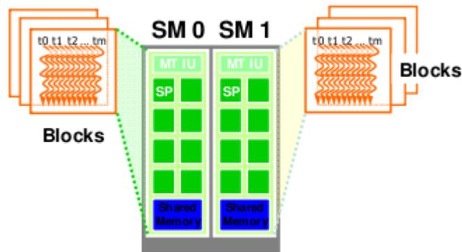
Fig. 4: Esquema de Multiprocesador ("Streaming Multiprocessor") y asignación de tareas.
