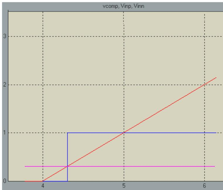
**Figura 63. Funcionamiento del comparador. Matlab/Simulink**
