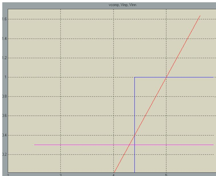
**Figura 65. Funcionamiento del comparador con offset independiente. Matlab/Simulink**
