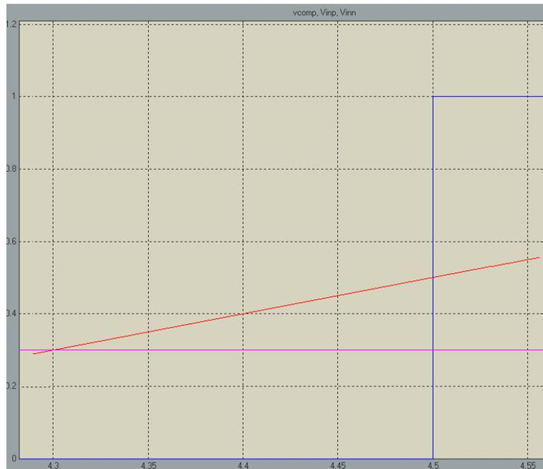
**Figura 64. Funcionamiento del comparador con retraso. Matlab/Simulink**
