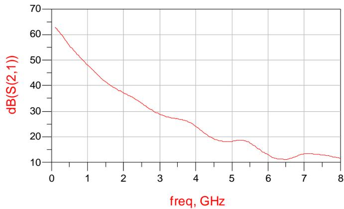
**Ilustración 11: Pérdidas de Inserción con Dos Amplificadores Reales en Cascada**
