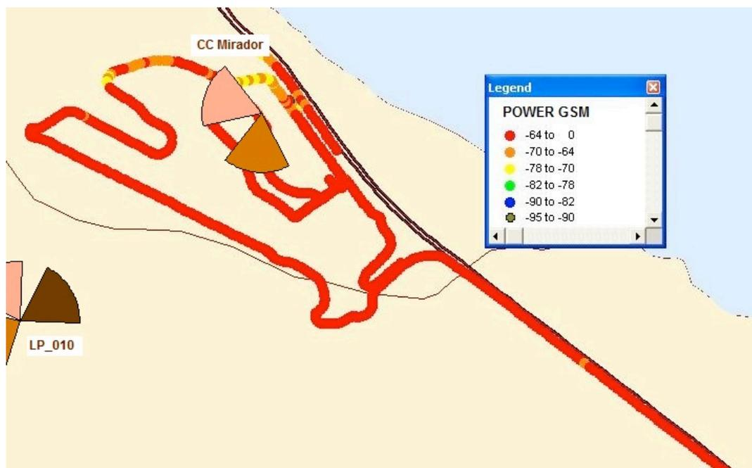
Figura 75: Potencia de señal en GSM
