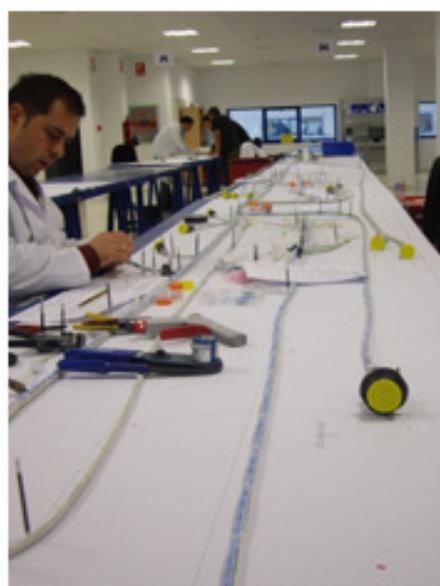
Figura 2.9. Mazo del cableado embarcado del A330.
