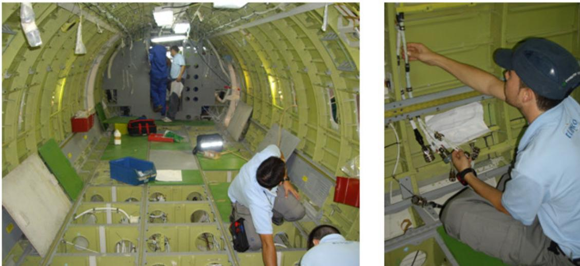
*Figura 2.10. Cableado embarcado (fuselaje)*
