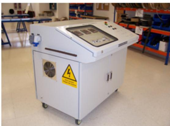
*Figura 2.6. Banco de Cargas para testear el motor eléctrico de emergencia RAT del A400M.*
