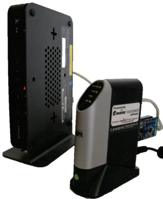
Figura 4.17 Conexión pasarela Tmote Connect con router
