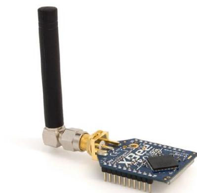
Figura 4.4: xBee 868 MHz con conector RP-SMA y antena sleeve dipole de 0 dBi.
