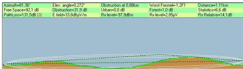
Figura 5.49: Radioenlace Repetidor 4 – Palmilla.
