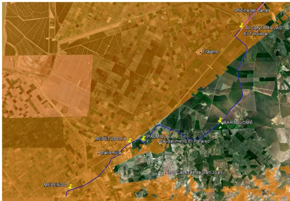
Figura 5.45: Mapa de cobertura de Melendo con link margen de 10 dB y situación de Repetidor 4.
