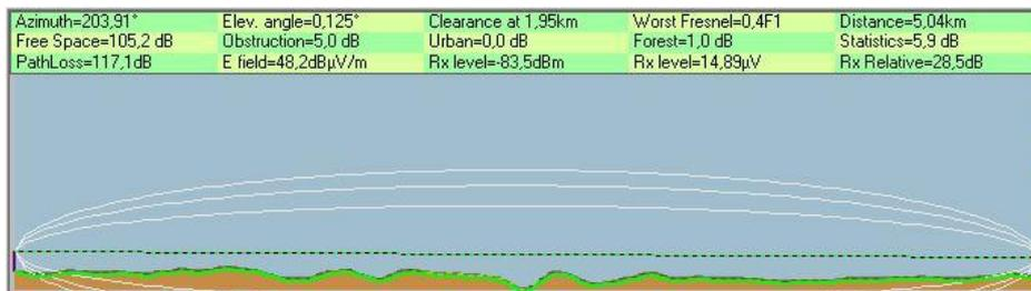
Figura 5.20: Radioenlace La Cabaña – Estructura 1.
