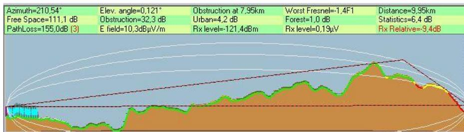
Figura 5.23: Radioenlace Estructura 2 – Merinales.
