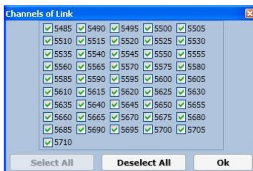
**Figura 3. 19 Canales disponibles para la banda 5.4GHz ETSI y un ancho de banda de canal de 20MHz**
