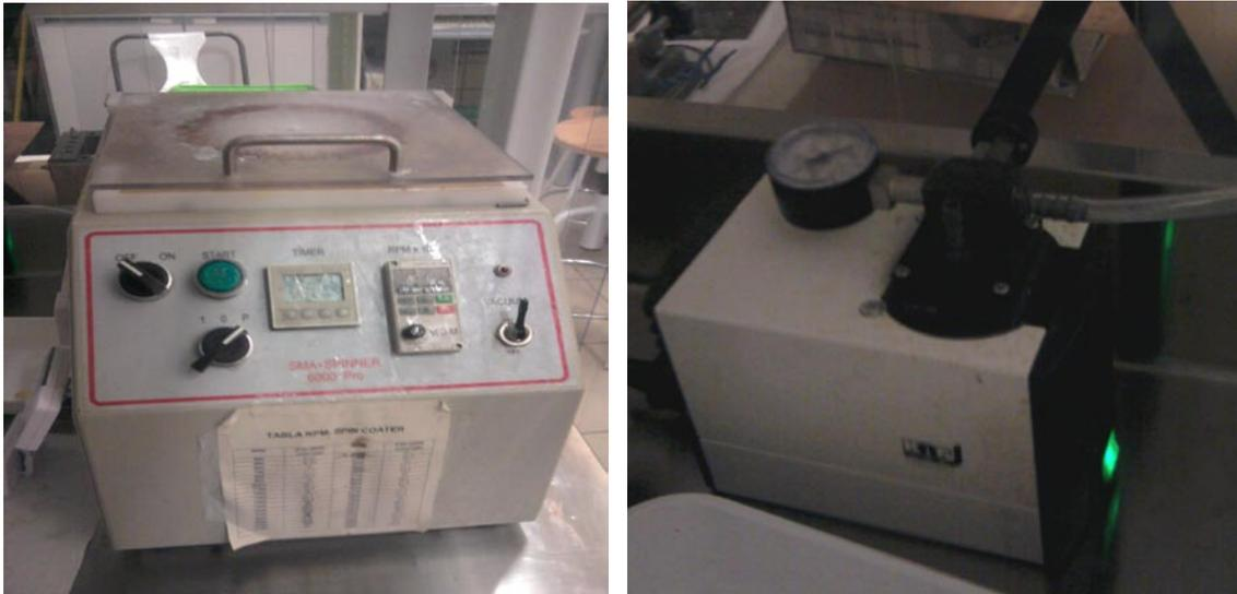
Figura 36. Spin Coater y bomba de vacío de izquierda a derecha.
