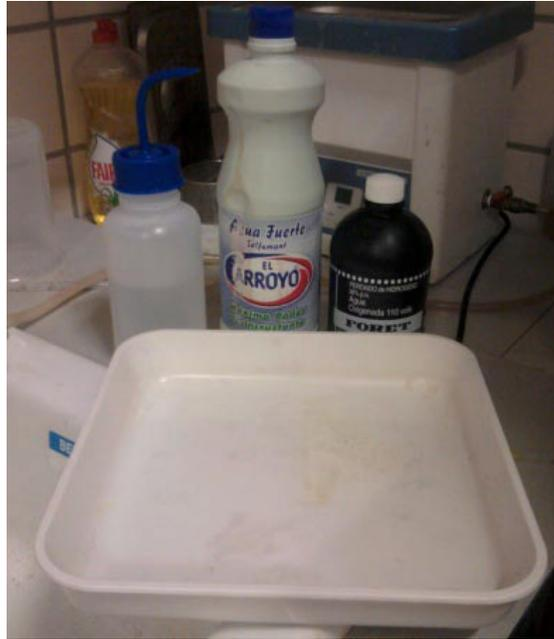
Figura 40. Bandeja, agua de grifo, agua fuerte y agua oxigenada.
