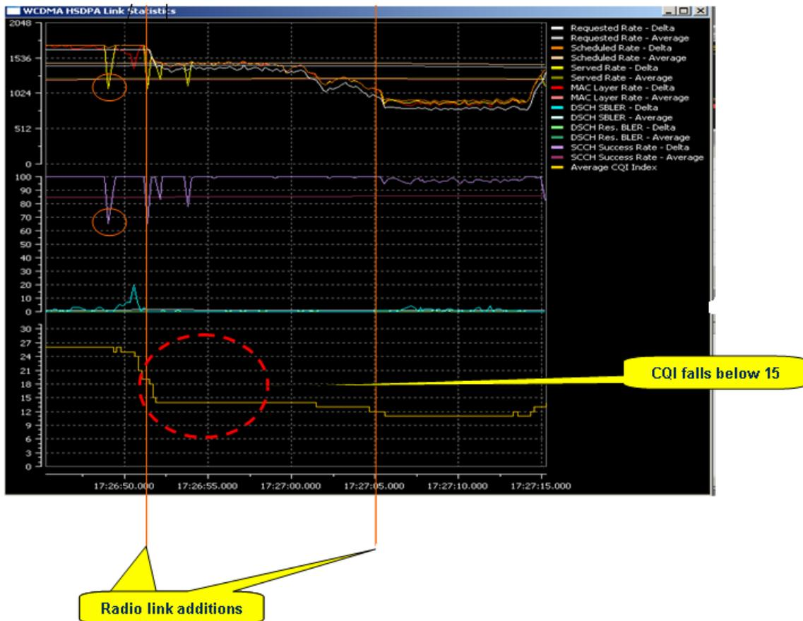
Figura 3 Degradación HSDPA en Active Set
