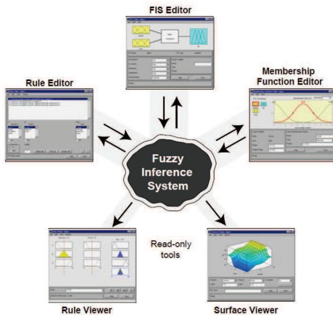
Figura 2.4.2: Herramientas de la interfaz gráfica de usuario de la Fuzzy Logic Toolbox.
