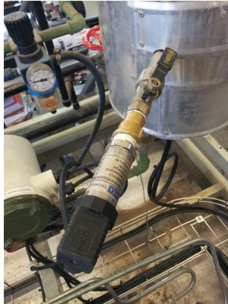
Figura 3.1.3: Sensor para el nivel del depósito.
