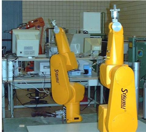
**Figura 1.4: Robots industriales Staubli RX90. Laboratorio de Sistemas y Automática.**
