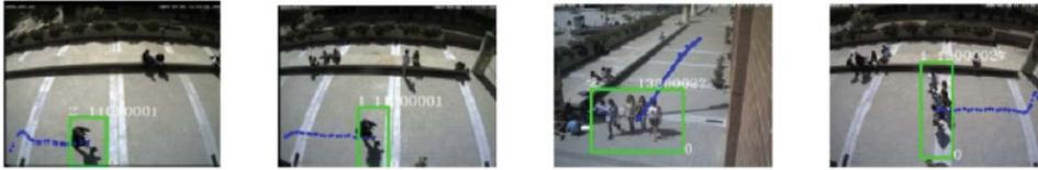
**Figura 1.15: Proyecto URUS. Tracking de personas mediante red de cámaras IP.**
