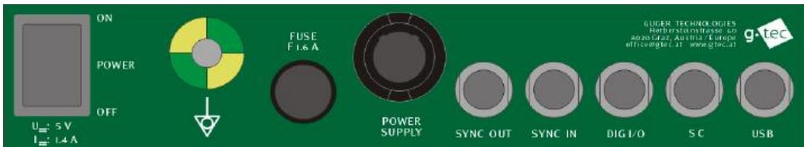
Fig. 6.1.1.3: Parte posterior. Switch de encendido, fusible, alimentación, sincronización con otro amplificador, entradas/salidas digitales y conexión USB.
