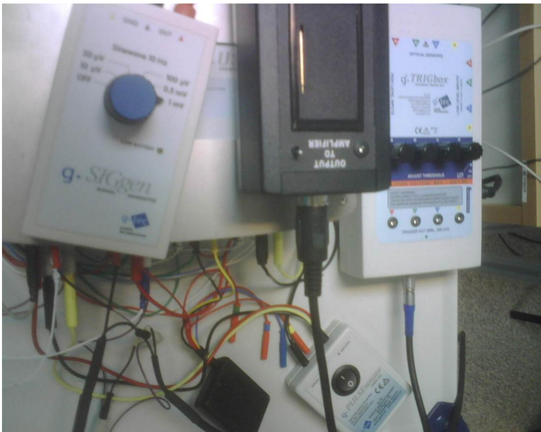
Fig. 7.7: Generador de señal senoidal (izquierda), generador de pulsos (abajo), 'trigger' (derecha).
