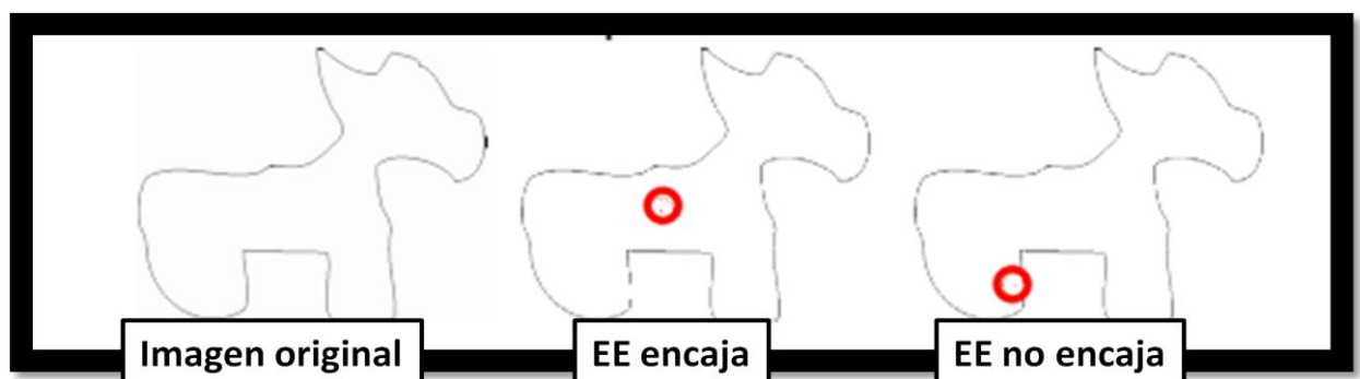
Figura 15. Elemento estructurante en forma de círculo. De izquierda a derecha se ve como el EE aplicado sobre la imagen original encaja o no en ella [16].
