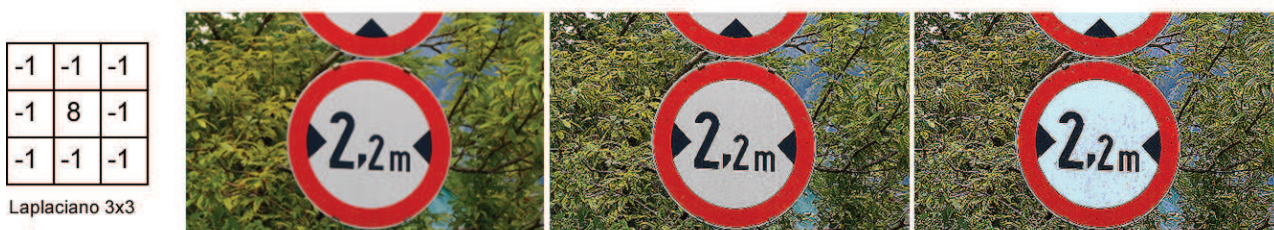
Figura 3.14. Máscara 3x3 del Laplaciano y resultados de perfilado.
