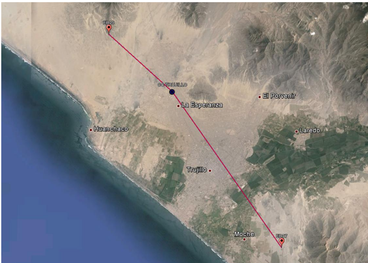
Imagen 24. Enlaces WIMAX con el Centro de Control Principal - Trujillo
