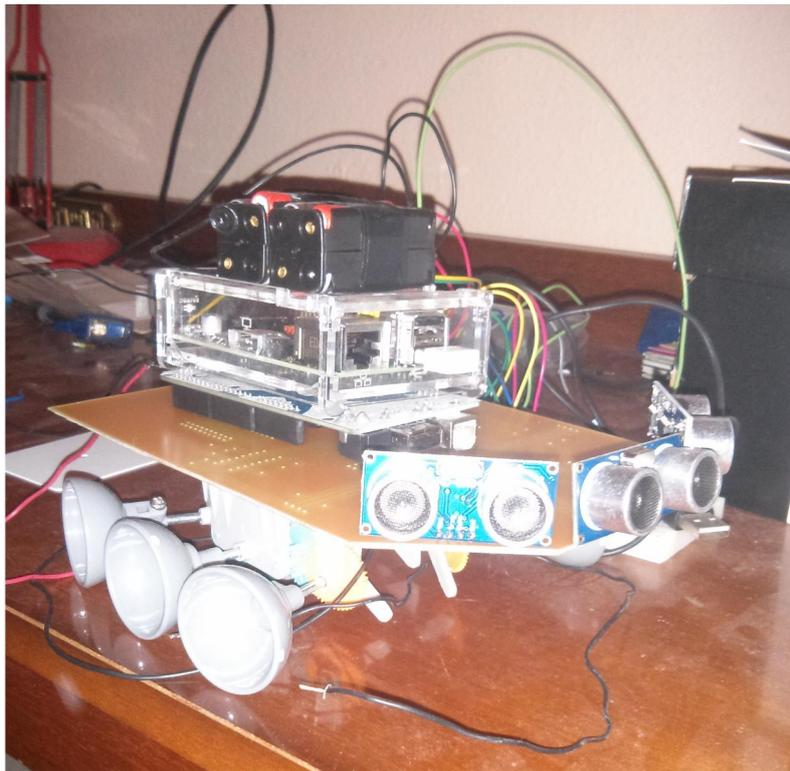
Se trata de un sistema robot móvil con dos grados de libertad. El cual puede reproducir mediante un simple proceso de programación el comportamiento descrito en los apartados anteriores. Tanto como un robot evitador de obstáculos como robot gestionado mediante controlador háptico haciendo uso de los sensores acelerómetros de un Smartphone.
