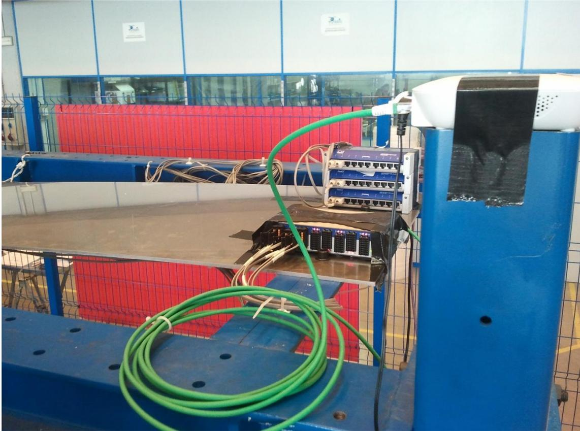
Figura 34. QuantumX® MX1615 conectado al punto de acceso WAP121 y módulos CANHEAD®.
