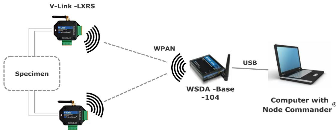
Figura 40. Esquema del prototipo Microstrain.
