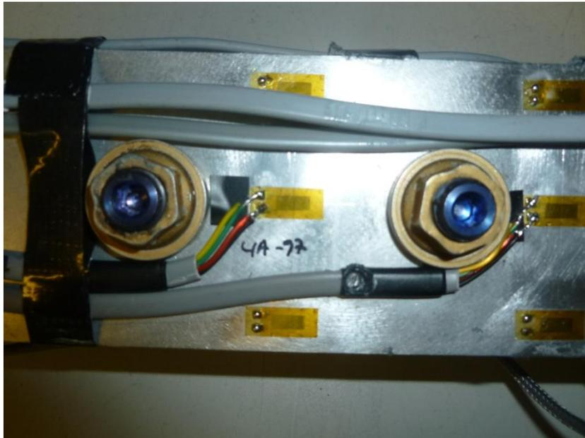
Figura 2. Galgas instaladas en un espécimen.
