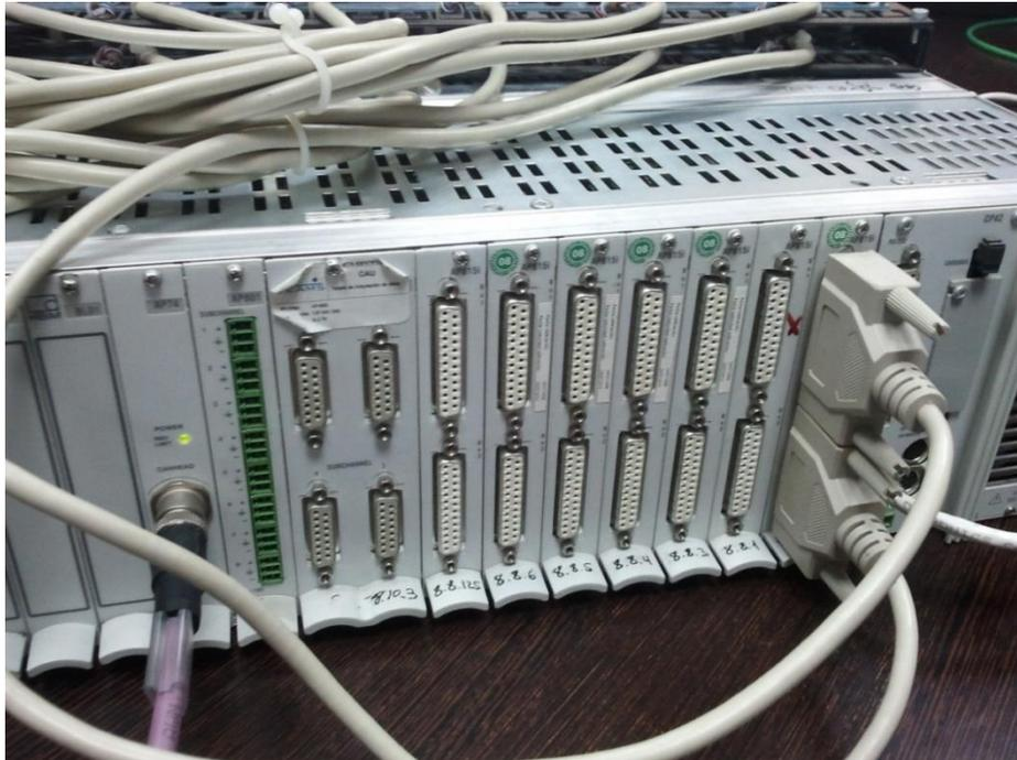
Figura 6. Placas conectoras de un MGCplus®.
