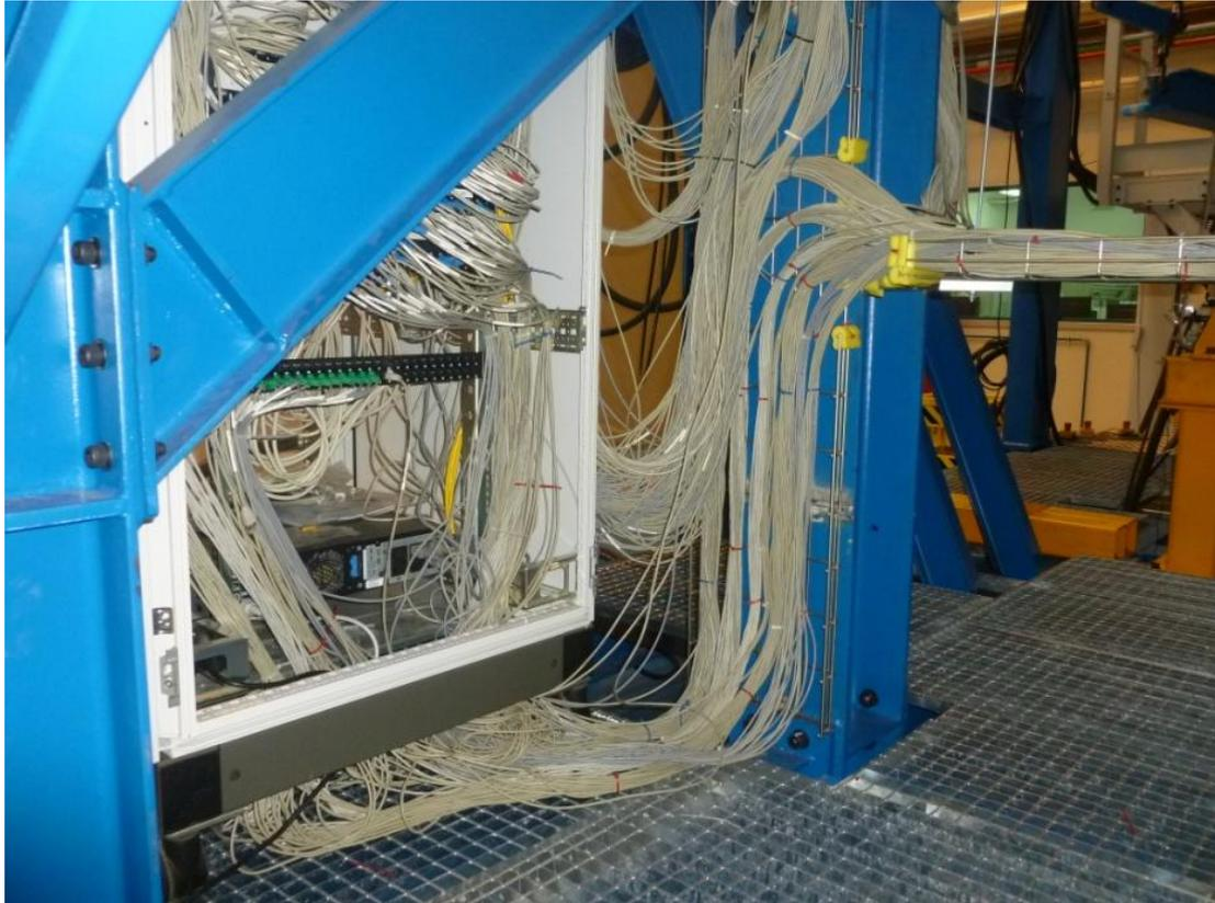
Figura 8. Sistema sensorial cableado problemático.
