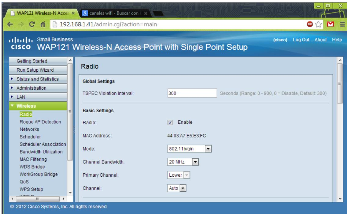
Figura 58. Activación de la interfaz radio.
