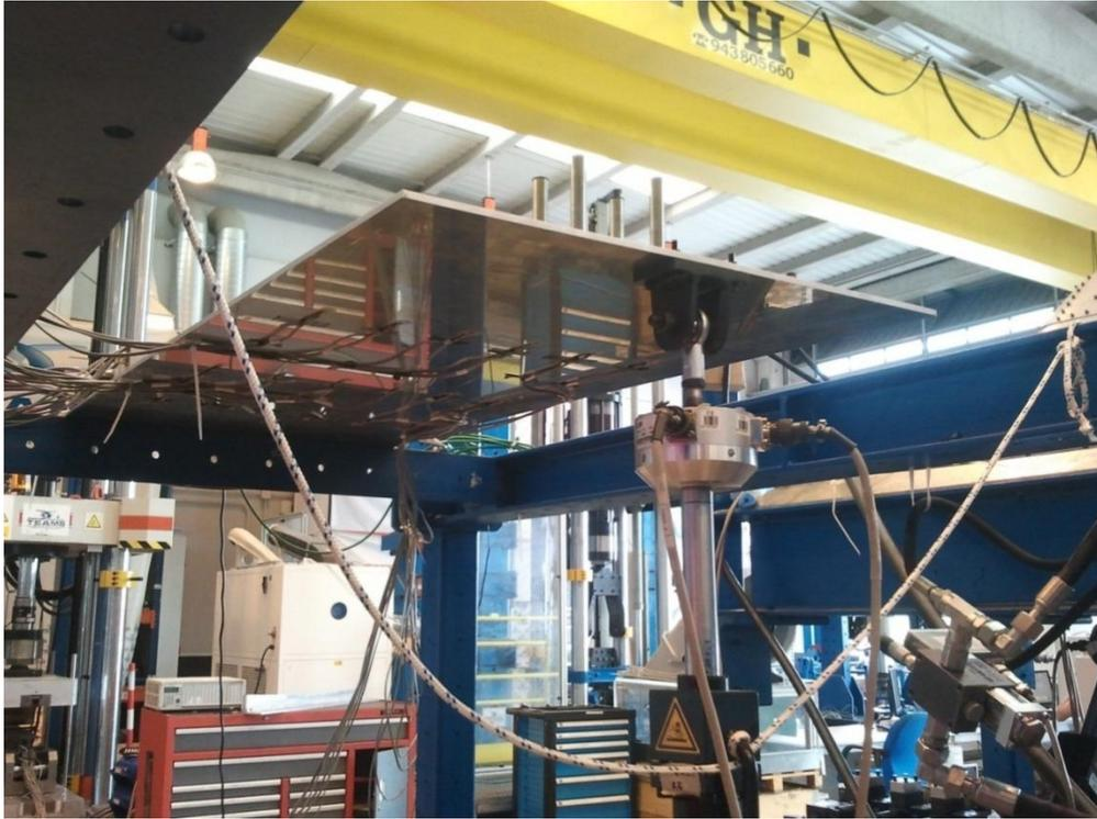
Figura 32. Actuador instalado en un lado del espécimen.
