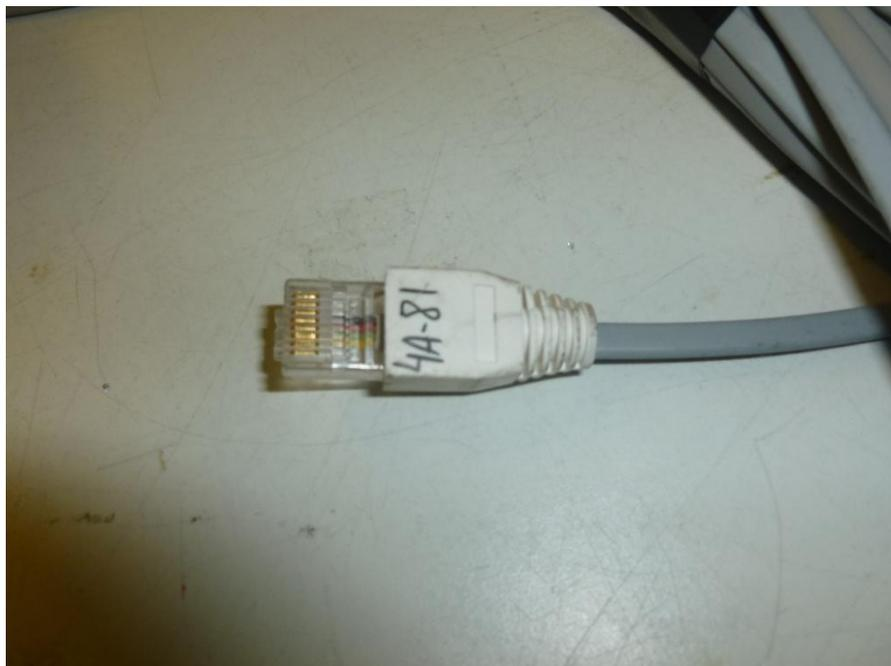
Figura 4. Conector RJ-45 para galga extensiométrica.
