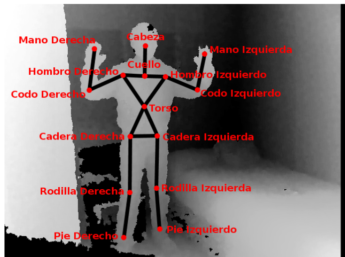
Figura 22: Esqueleto humano detectado por Kinect. Imagen no espejada, por lo que el brazo izquierdo se sitúa a la derecha de la imagen y al revés para la extremidad opuesta.
