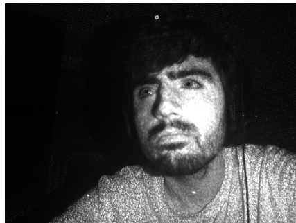
Figura 5: Imagen infrarroja tomada con el Kinect 1.0, cámara de luz estructurada. Obsérvense los diversos puntos que componen la resolución del sistema, así como las sombras.
