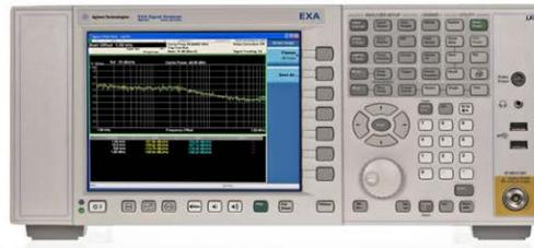
**Figura 7.2** Analizador vectorial de señal Agilent EXA N9010A.
