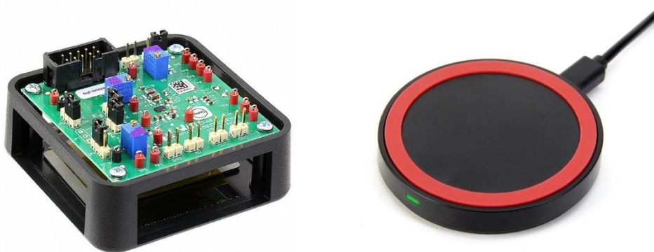
Figura 2-10. Texas Instruments bq51050BEVM-764 y Cargador Qi genérico
