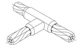
DETALLE SOLDADURA ALUMINIO TERMICA
