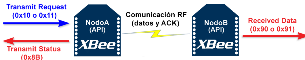
Figura 3.4 Ejemplo gráfico del intercambio de tramas de datos con un nodo remoto.
