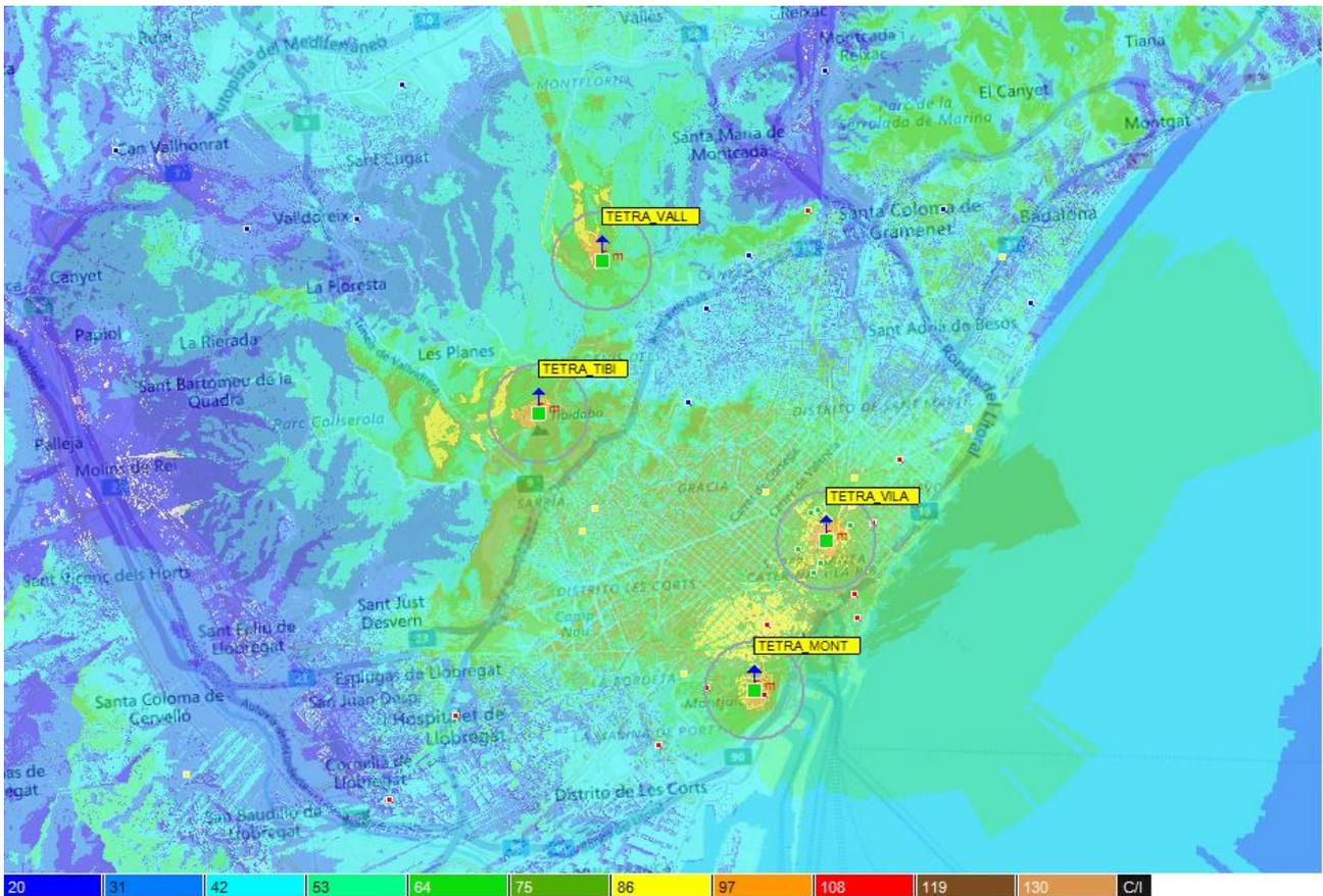
Figura 4.67. Mapa C/I: mínimo C/I en mejor servidor DMR tras ajuste de frecuencias (Caso 1)
