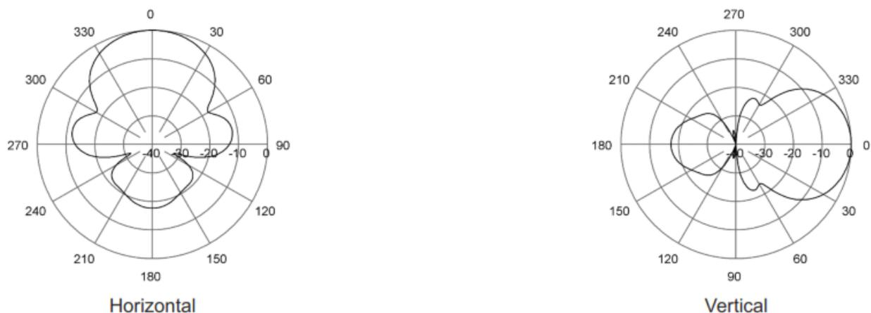
Figura 4.4. Patrón de radiación de antena direccional TETRA para RTU
