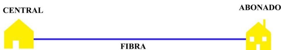
Figura 10: Esquema básico arquitectura P2P.
