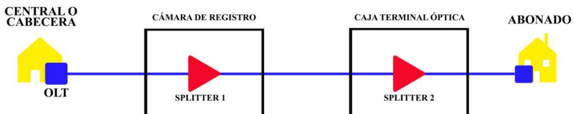
Figura 13: Elementos principales de una red de fibra.
