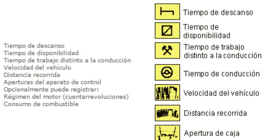
Figura 2: leyenda de interpretación de las marcas imprimidas por un tacógrafo analógico.
