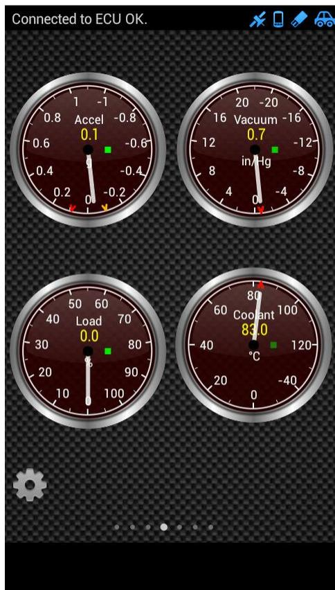
Figura 26: captura de pantalla del terminal Android ejecutando la app *Torque Lite* mientras esta se comunica con la *ECU* del vehículo real.
