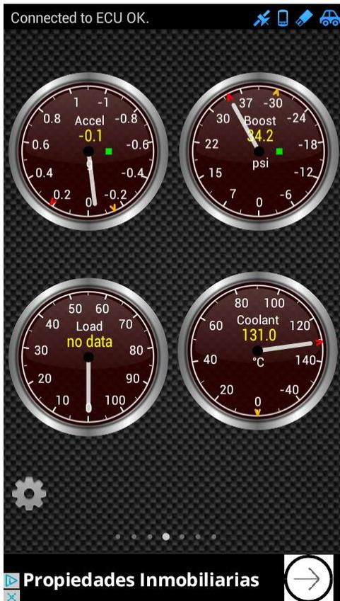
Figura 21: captura de pantalla del terminal Android durante la ejecución de la app *Torque Lite* mientras se comunica con el simulador *OBDSim*.
