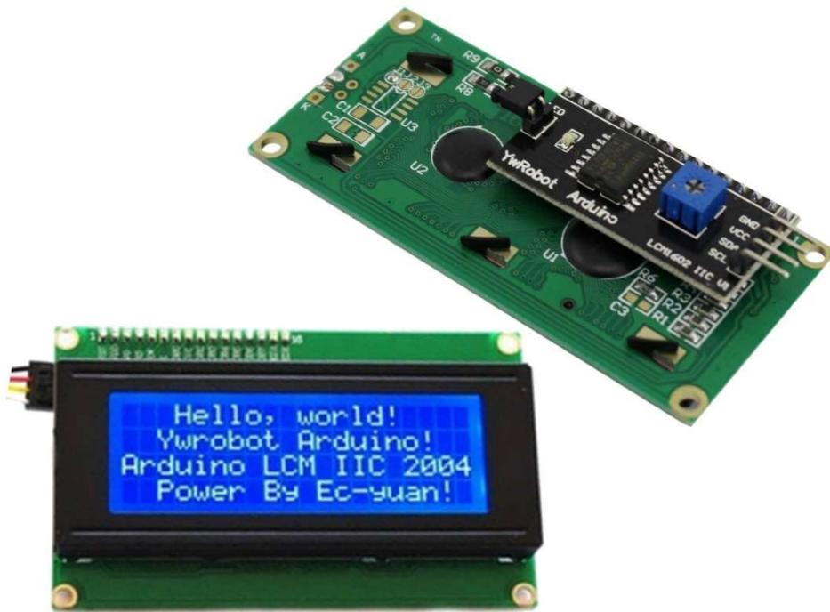
Ilustración 4.6: Icd 20x4 con módulo I2C
