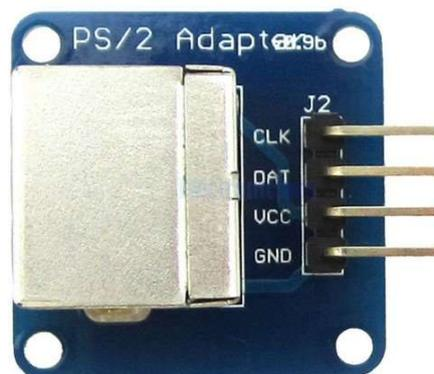
**Ilustración 4.9: Modulo adaptador a PS/2 simplificado para usar sólo protocolo I2C**
